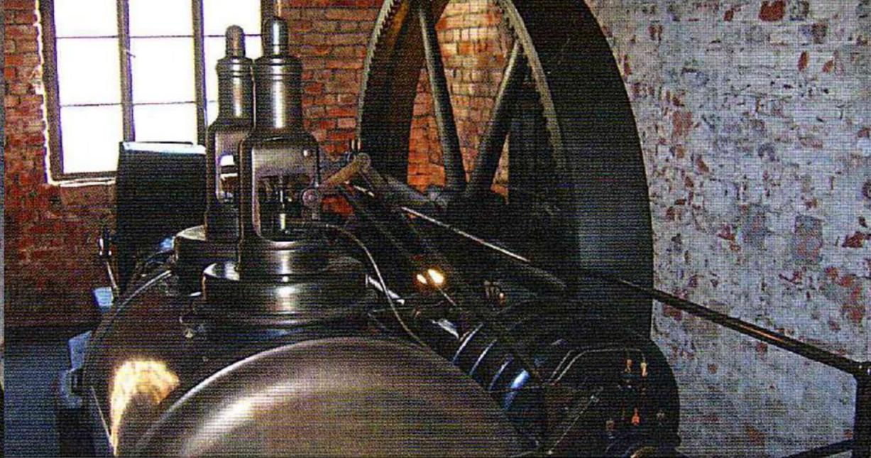
Die im Jahre 1907 gegründete Möbelfabrik Weinhold installierte eine 1901 als Nr. 399 im Jacobiwerk Meißen gebaute, zuerst in einer Ziegelei benutzte, liegende Einzylinder Gegendruckdampfmaschine, die bis 1991 in Betrieb war.
